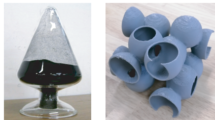
図3 カーボン新素材「グラフェンメソソポンジ」の外観とナノ構造模型 (写真提供：東北大学・岩村振一郎特任准教授)
